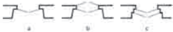
Obr. 12. Schéma tří typů tradičních oken (půdorys): a) jednoduché dovnitř otvíravé okno; b) dvojitě dovnitř a ven otvíravé okno; c) dvojitě dovnitř otvíravé okno.
