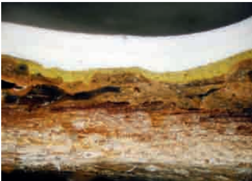
Obr. 1. Mikroskopický snímek sledu nátěrů. Ze snímku je patrné, že byl prvek upravován nejprve v okrovém a žlutém odstínu, poté byl dvakrát opatřen bílým nátěrem. (Autorkou fotografií v této kapitole je Petra Lesniaková.)
